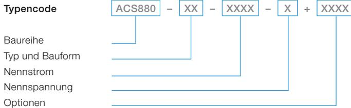
eindeutige Typenbezeichnung, aus der Bauform, Strom- und Spannungsbereich erkennbar sind. Die Optionen werden durch einen "Plus-Code" an die Typenbezeichnung angefügt. Erstellen Sie mit Hilfe des folgenden Schlüssels Ihre eigene Typenbezeichnung oder wenden Sie sich an Ihre lokale ABB-Vertriebsniederlassung und teilen Sie Ihre Wünsche mit.
